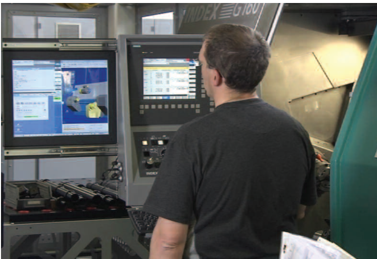
Figura 7: Los operadores de máquinas pueden verificar los programas de NC y la configuración de la máquina para el siguiente trabajo al utilizar la máquina virtual sin incorporar la máquina-herramienta física.
